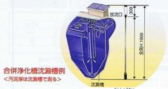
合併浄化槽沈殿槽例
